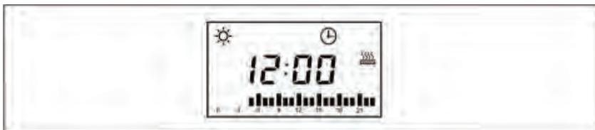
L'illustration précédente montre le jour actuel. Il est indiqué dans l'axe des temps en bas de l'illustration que le radiateur fonctionne à partir de 5 heures du matin. L'écran indique que l'appareil de chauffage fonctionne actuellement en mode Confort et le symbole de chauffage indique que l'appareil continue de chauffer.
