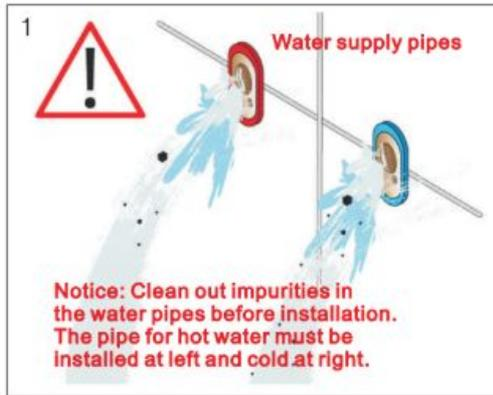
Remarque : Avant l'installation, veuillez à éliminer toutes les impuretés des conduites d'eau. Le tuyau d'eau chaude doit être installé à gauche, et celui d'eau froide à droite.
