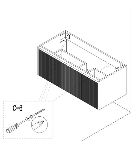
4. Soulevez le meuble de salle de bain (il est recommandé d'être à deux), alignez-le sur les trous correspondants et vissez les vis dans le mur à l'aide d'un tournevis Ø6\*70. Vérifiez que le meuble est solidement fixé.
