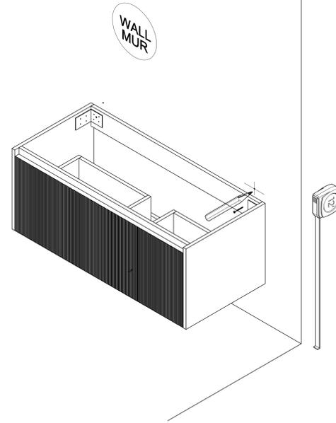
1. Déballez soigneusement le meuble, mesurez l'emplacement correspondant sur le mur et marquez l'emplacement des trous. (La hauteur recommandée du plan de travail par rapport au sol est généralement de 850 mm.)
