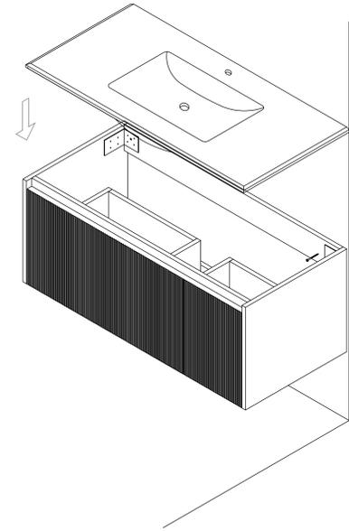
5. Déballez soigneusement le plan de travail. Placez le plan de travail sur le meuble principal et ajustez sa position à gauche, à droite, à l'avant et à l'arrière. (Il est conseillé d'installer la robinetterie et les autres accessoires à cette étape.)
