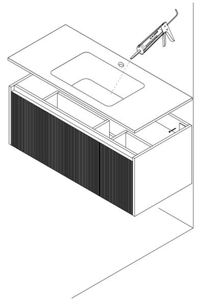
6. Utilisez du mastic silicone derrière le plan de travail et le long des bords du mur pour sceller le plan de travail au mur, assurez-vous que le plan de travail est fixé.
