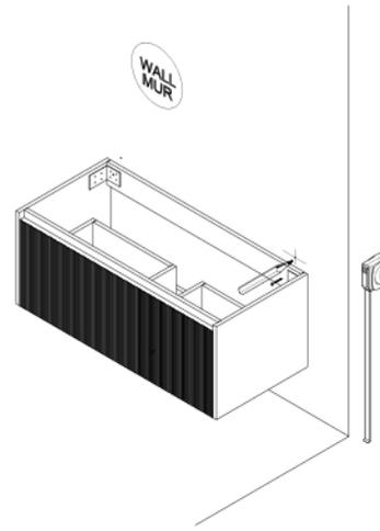
1. Déballez soigneusement le meuble, mesurez l'emplacement correspondant sur le mur et marquez l'emplacement des trous. (La hauteur recommandée du plan de travail par rapport au sol est généralement de 850 mm.)
