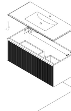
5. Déballez soigneusement le plan de travail. Placez le plan de travail sur le meuble principal et ajustez sa position à gauche, à droite, à l'avant et à l'arrière. (Il est conseillé d'installer la robinetterie et les autres accessoires à cette étape.)
