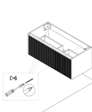
4. Soulevez le meuble de salle de bain (il est recommandé d'être à deux), alignez-le sur les trous correspondants et vissez les vis dans le mur à l'aide d'un tournevis Ø6\*70. Vérifiez que le meuble est solidement fixé.
