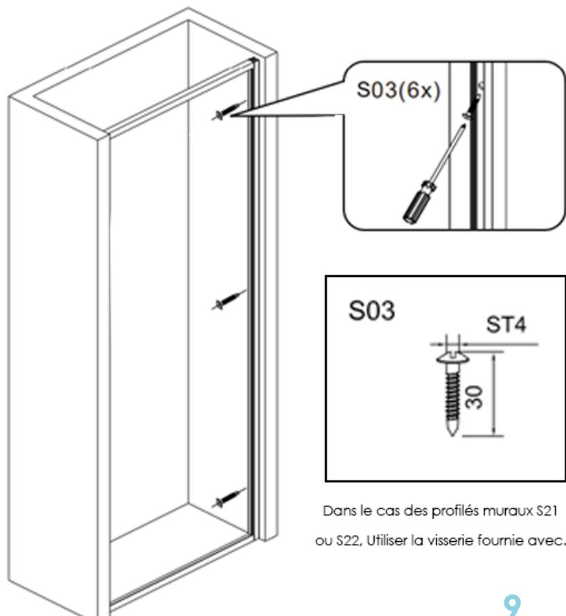
9. Présenter le cadre de porte avec le deuxième profilé et fixer le tout au mur en utilisant Les vis S03 ( dans le cas où le profilé installé est un S21 ou S22, utiliser la visserie fournie avec )
