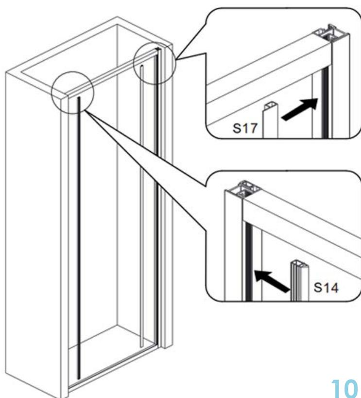
10. Insérer les joints S17 et S14 dans le cadre de porte, en respectant le sens, ( se référer au schéma ci-contre ).
