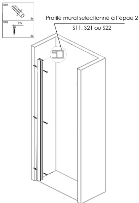
8. Afin de faciliter la Pose, il est conseillé d'installer un profilé sur deux au mur, avant de fixer le cadre de porte.
