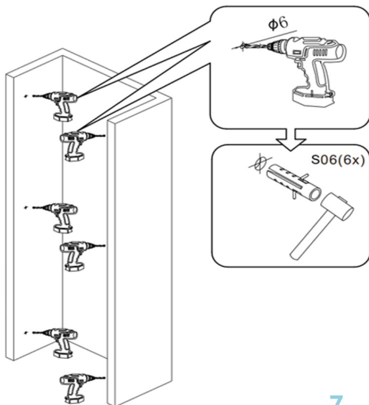
7. A l'aide d'une mèche de 6 mm de diamètre, percer aux points de marquage, et insérer les chevilles.
