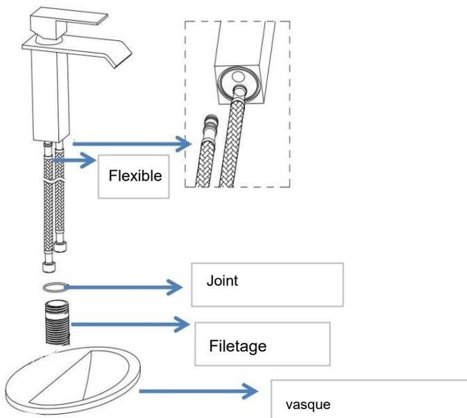
Connecter le tuyau d'entrée d'eau au robinet, puis placer le joint inférieur et serrer la vis de fixation.
