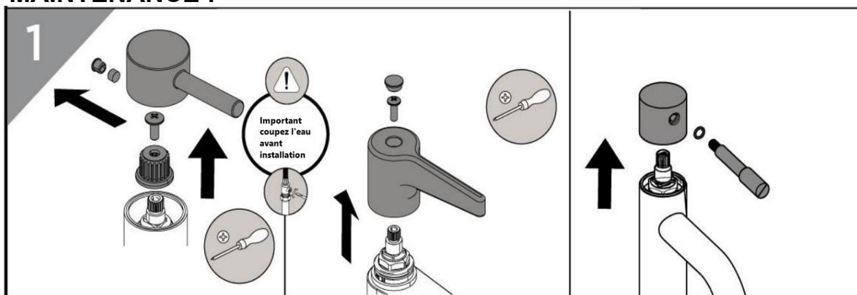
1. Démontez les poignées et les couvercles, y compris les éventuels adaptateurs cannelés si utilisés, installez les parties supérieures sur le corps du bassin en céramique,
