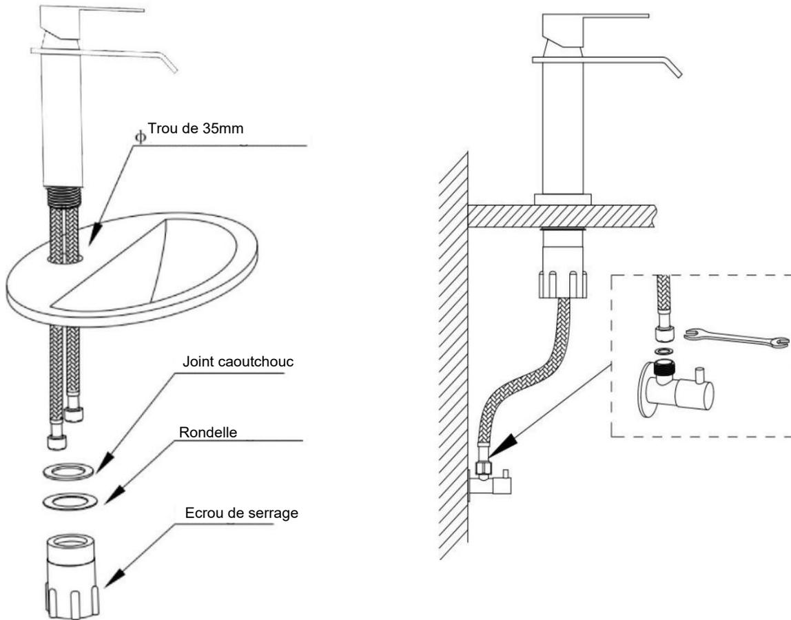
2. Assurez-vous que le bassin a un trou traversant de  $\varnothing 35$  mm, passez le tuyau à travers le trou, passez l'anneau en caoutchouc, la rondelle et l'écrou de fixation
