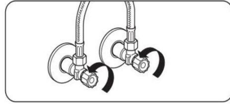
2. Robinet -robinet à jets- Raccordement de l'alimentation en eau
