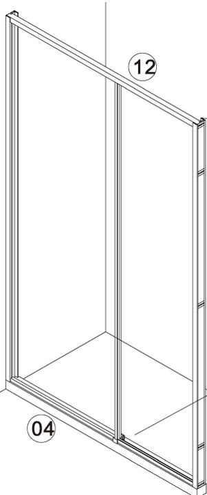
Insérez le rail supérieur en position sur le verre comme indiqué. Il est conçu pour être fixé par serrage. Utilisez un maillet pour taper.
