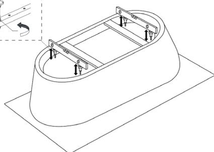
4. Muni d'une couverture, d'un carton ou d'une autre surface protectrice, retournez la baignoire afin de laisser accès aux pieds pour procéder à leur mise à niveau en les tournant.
