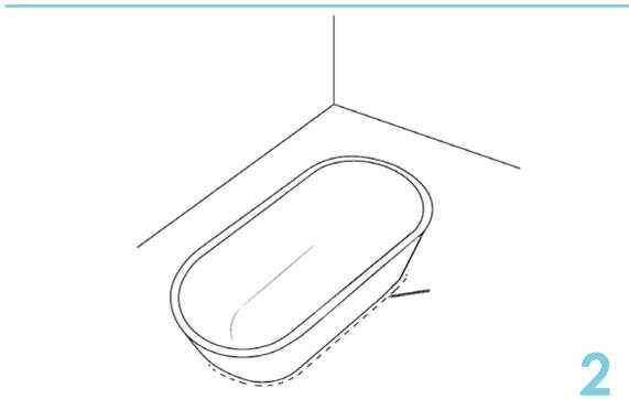
2. Placez la baignoire dans la position d'installation exacte au sol et tracer le contour de la baignoire avec un crayon ou tout autre marquage effaçable.
