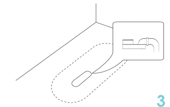
3. Déterminez l'emplacement du trou de vidange au sol, en fonction du tuyau provenant de la baignoire.
