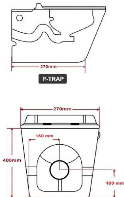
△ Attention à la dimension nécessaire au bon raccordement du vidage.
