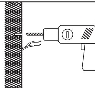
1. Couper l'alimentation électrique avant de réaliser les trous de Ø6 dans le mur
