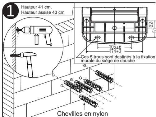
1. Percez 5 trous dans le mur en fonction des emplacements prévus sur la fixation du siège de douche (foret de  $\varnothing 10$  mm, profondeur des trous de 6,5 cm, selon la longueur des vis). Ensuite enfoncez les chevilles dans les trous du mur à l'aide du marteau.
