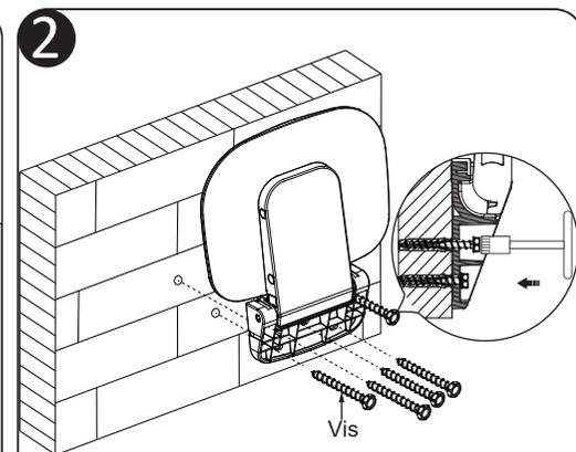
2. Placez le siège de douche sur le mur, alignez les trous de vis avec les trous du mur, puis serrez les vis avec une clé à douille.
