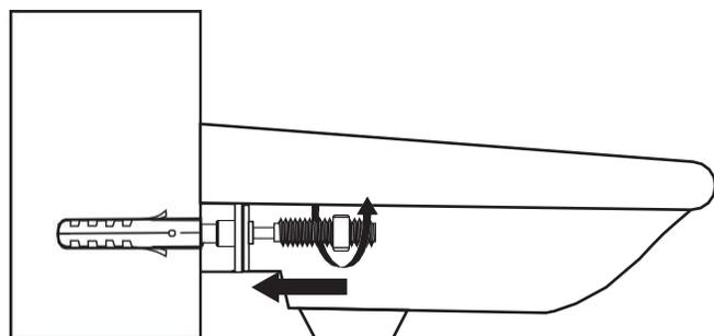
5. Vissez un écrou métallique sur chaque boulon de fixation pour fixer le bassin. **Attention :** Ne pas trop serrer, car cela pourrait endommager la céramique.
