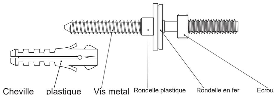
**Remarque :** Ces fixations conviennent uniquement aux murs pleins. Les murs en plaques de plâtre ou à ossature peuvent nécessiter des fixations spécialisées (non fournies).
