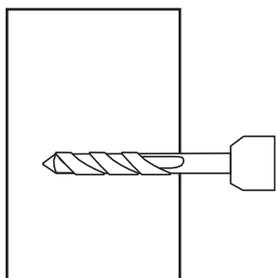
1. Percez deux trous dans la position requise sur le mur à l'aide d'un foret à maçonnerie de 14 mm, à une profondeur de 75 mm.
