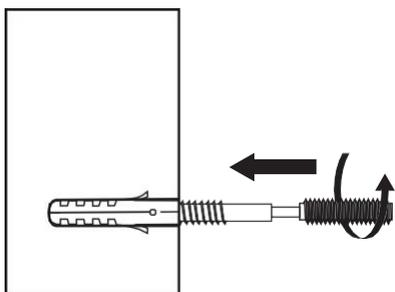
3. Vissez la fixation dans chaque cheville à l'aide d'une clé de 8 mm jusqu'à ce que la clé entre en contact avec le mur.
