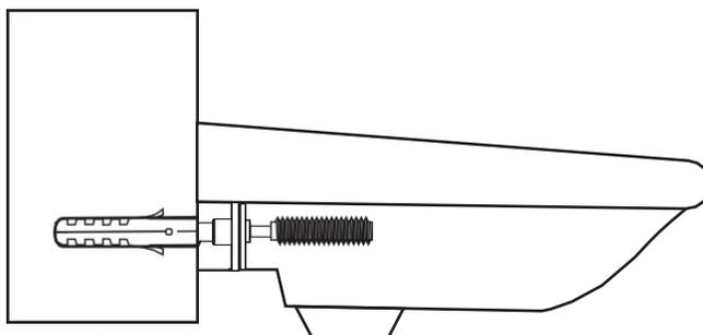
4. Placez le lavabo en position contre le mur. Positionner les boulons de fixation à travers les trous à l'arrière du bassin. Posez une rondelle en plastique suivie d'une rondelle en métal sur chaque boulon de fixation.
