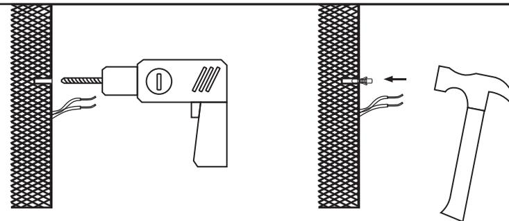
1. Couper l'alimentation électrique avant de réaliser les trous de Ø6 dans le mur
