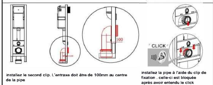
installez le second clip. L'entraxe doit être de 100mm au centre de la pipe
