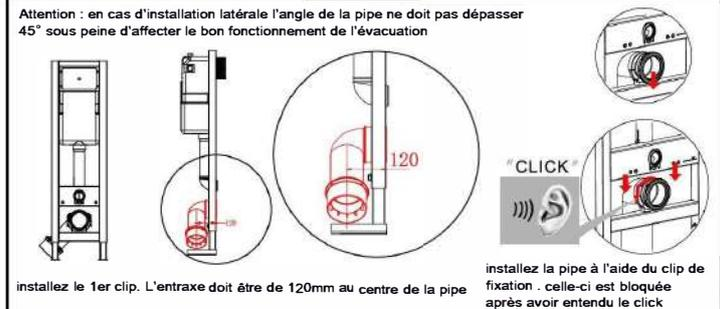
installez le 1er clip. L'entraxe doit être de 120mm au centre de la pipe
