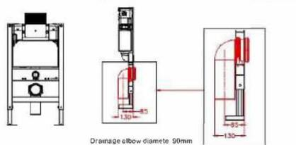
installez le second clip. L'entraxe doit être de 130mm au centre de la pipe
