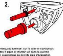
mettez du lubrifiant sur le joint en caoutchouc des 2 pipes et insérez les dans la cuvette. L'écartement du point de pipe d'évacuation voir 5.1, 5.2, & 5.3
