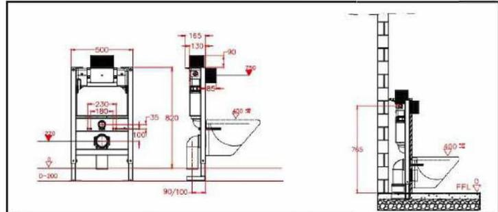
Remarque : en cas d'installation de la plaque par le dessus, l'espacement entre la surface finie des carreaux muraux et le boîtier de support de plaque doit être supérieur ou égal à 30 mm
