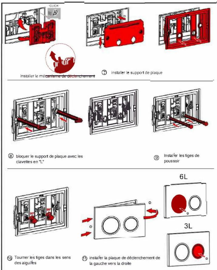
Installer le mécanisme de déclenchement
