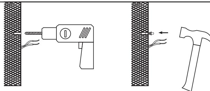
1. Couper l'alimentation électrique avant de réaliser les trous de  $\text{Ø}6$  dans le mur
