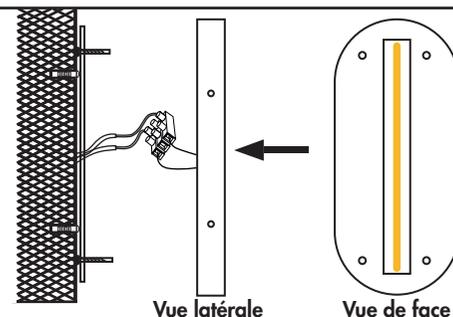
4. Câble de connexion : ne retirez pas les fils connectés
