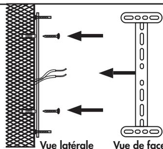
3. Fixer le support métallique en forme de "H" au mur
