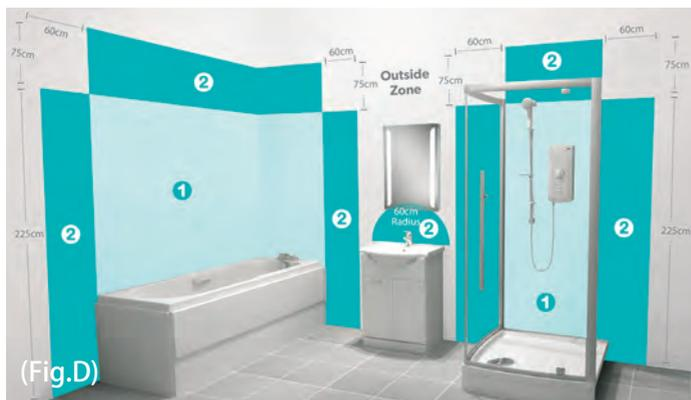
Toutes les installations doivent respecter des directives basées sur un concept de zone. Le schéma (Fig. D) illustre ce concept et doit être suivi pour assurer l'installation sécuritaire des appareils électriques dans la salle de bain.
