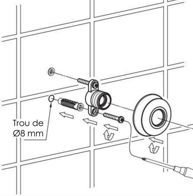
Percez 2 trous de Ø8 mm au niveau des marques sur le mur et insérez les chevilles. Fixez le support mural avec des vis autotaraudeuses. Installez le cache et plaquez-le au mur. Réinstallez le support de la douchette et fixez-le avec le collier de serrage.
