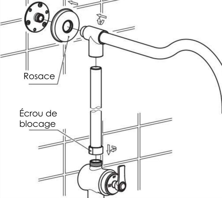
Réinstallez le bras de douche sur le support mural avec la rosace, maintenez la rosace contre le mur. Installez la colonne et fixez-la avec un écrou de blocage.
