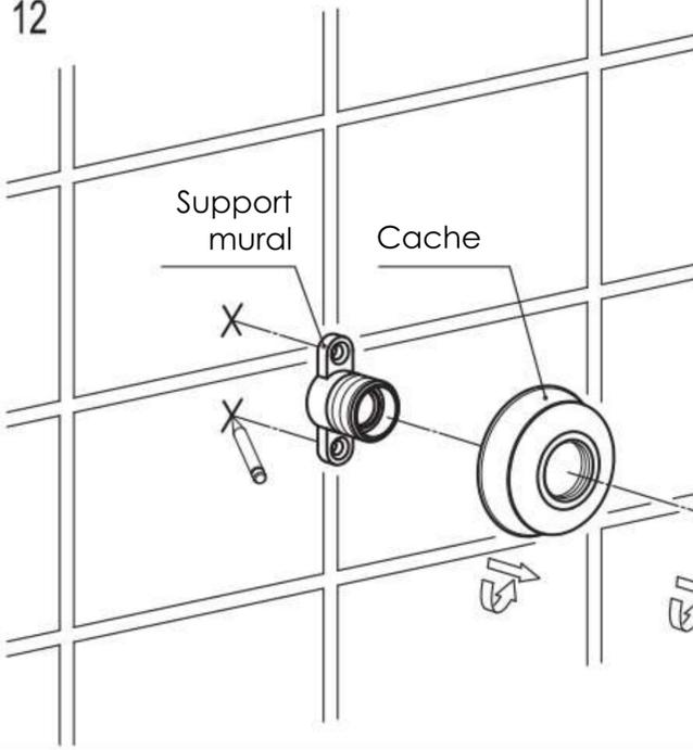
Dévissez le collier de serrage du support de la douchette. Retirez le cache et marquez sur le mur l'emplacement des trous du support mural (la hauteur conseillée est de 600 mm au-dessus du robinet).
