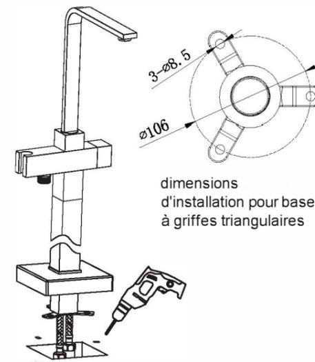
7. installez le corps du robinet par les vis d'expansion.
