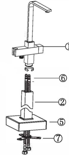
2. connectez le tube au corps principal par une vis hexagonale.
