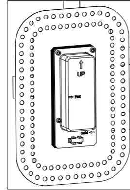
Installez la plaque en caoutchouc sur le corps du boîtier et fixez-la à la surface du béton.
