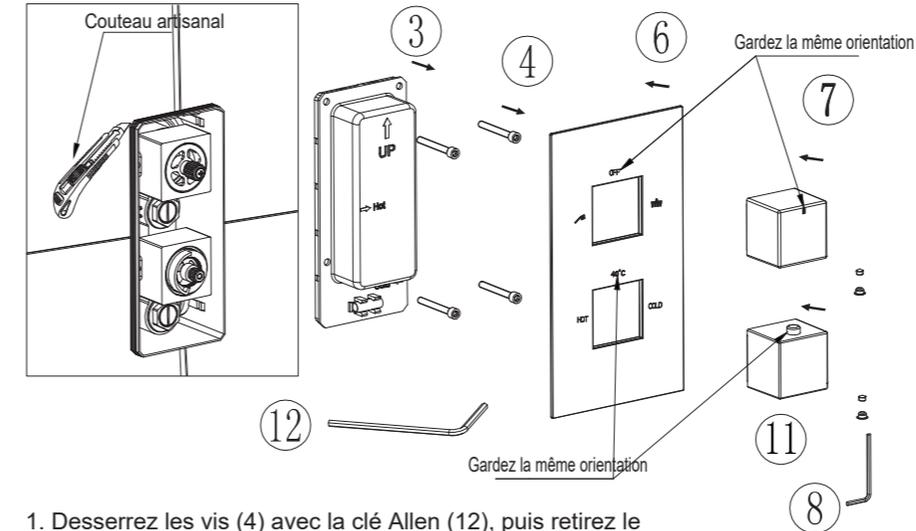
1. Desserrez les vis (4) avec la clé Allen (12), puis retirez le couvercle supérieur (3).
