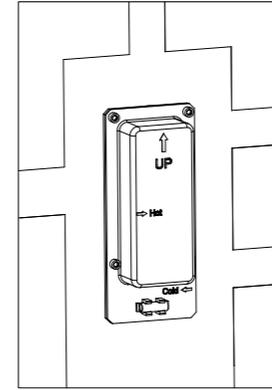
Commencez le test de pression pour vérifier l'absence de fuite avant de remplir le mur avec du béton.
