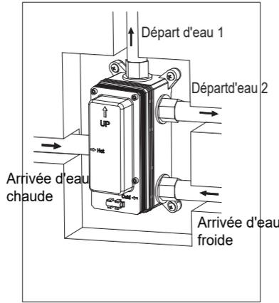
Raccordement de tous les tuyaux d'entrée et de sortie. Remarque : avant le raccordement, ouvrez la vanne principale pour éliminer les impuretés dans les tuyaux.
