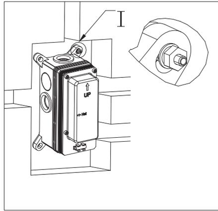
Fixez le boîtier au mur avec des vis à expansion et une clé. Vérifiez la jauge de niveau pour assurer un alignement horizontal et gardez toujours la flèche vers le haut.
