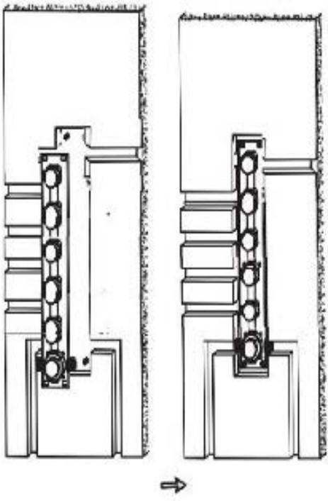
7. A l'aide de l'outil adéquat visser les vis jusqu'au serrage complet du corps sur le mur
