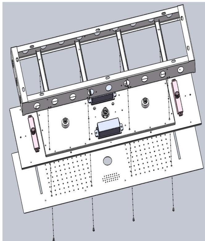
2. Creuser le trou sur le plafond selon la dimension des vis. utiliser un marteau pour frapper les vis dans les trous, puis installer le support sur les vis d'expansion, utiliser une clé pour bloquer les vis.
