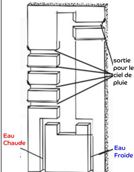
4. Percez les trous de fixation de la platine du corp à encastrer
