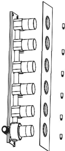
3. En prenant les dimension du corps a encastrer creusez le mur en fonction des sortie et entrée d'eau et du corps en lui même
