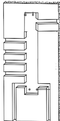
5. Insérez au marteau les 4 chevilles expansives dans les trous prévus à cet effet à l'aide d'un marteau
