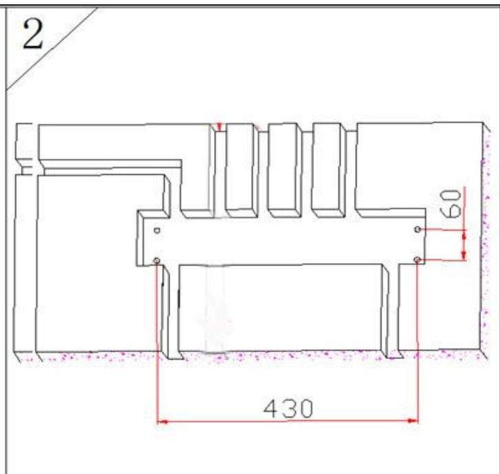
Positionnez l'emplacement des vis selon schéma ci-dessus
