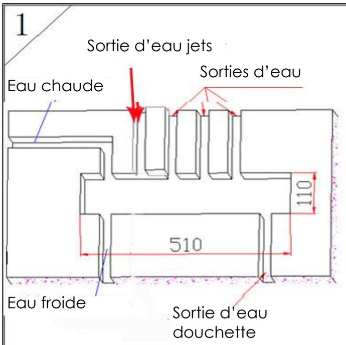
Creuser les espaces d'encastrement des tuyaux dans le mur selon les spécificités du modèle
