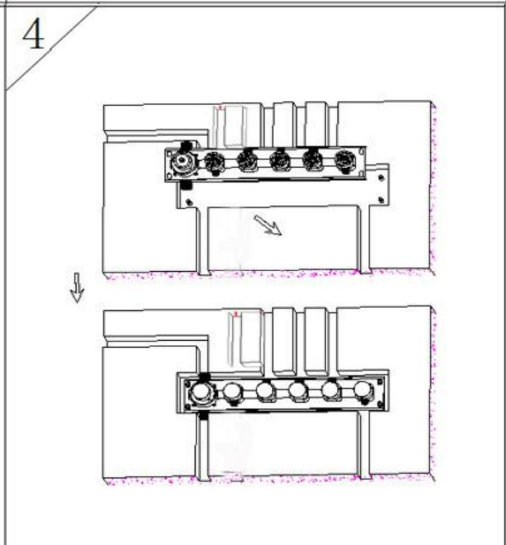
Fixer le corps d'encastrement avec les 4 vis
