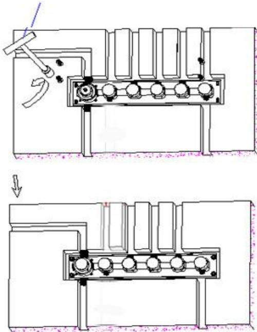
Retirez les tête de vis d'expansion des rondelles et utilisez une clé à douille pour verrouiller et fixer les têtes sur le corps encastré
