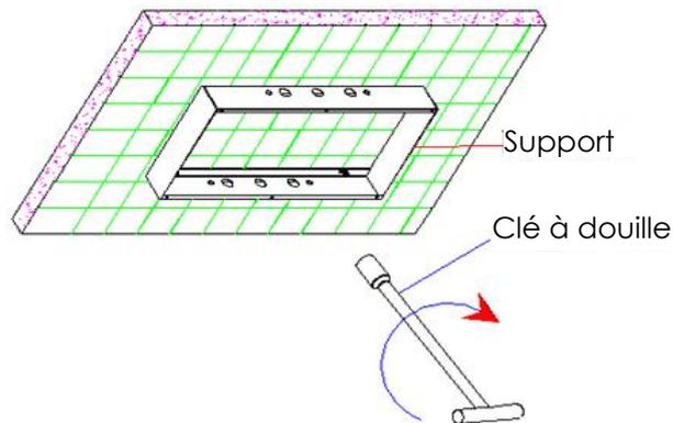
Installez le support sur les vis d'expansion puis utilisez une clé à douille pour visser les 4 vis de blocage
