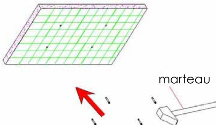
Utilisez un marteau pour insérer les 4 vis dans les trous
