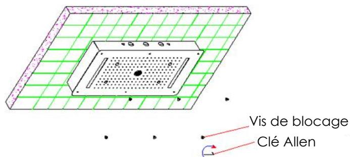
Fixer la façade sur le support en tournant les boulons de verrouillage
