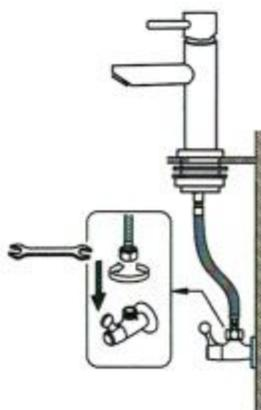
Branchez les tuyaux d'arrivée d'eau : "Rouge" pour la connexion à l'eau chaude et "Bleu" pour la connexion à l'eau froide.
