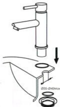
Assurez-vous qu'il y a un trou de 35 à 40 mm sur la vasque avant de fixer le robinet. Dévissez le raccord du bas du corps, puis faites-le passer à travers le trou. N'oubliez pas de fixer le joint torique entre le bas du corps et la vasque.
