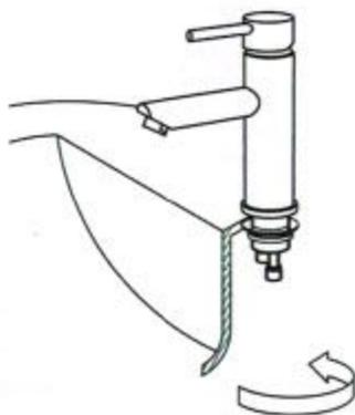
Vissez à la main le contre-écrou, puis renforcez la fixation avec un outil adapté.
