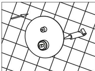
4. Fixer la plaque du mitigeur sur le corps d'encastrement avec les vis et installer la poignée
