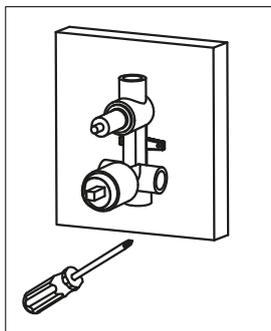
1. Placer le corps d'encastrement dans le mur en vous aidant du niveau à bulle.
