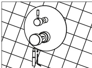
5. Ajouter la manette sur la poignée en la fixant avec la vis et la clé Allen
