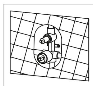
3. Découper l'emplacement du boîtier d'encastrement dans le mur ou placo (prévoir environ 5 mm de plus de chaque côté). Laisser les protections pour l'instant.
