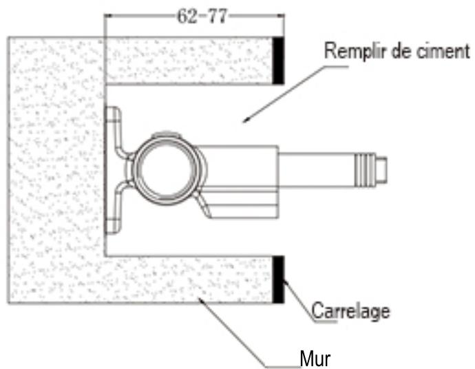
4. Installer les pipes de scellement.
