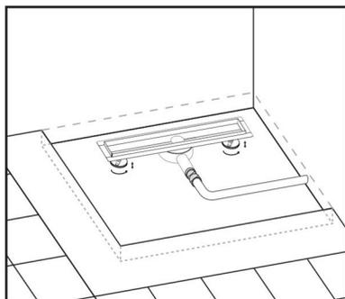
Connectez le tuyau de vidange à la sortie d'eau du drain de la douche.
