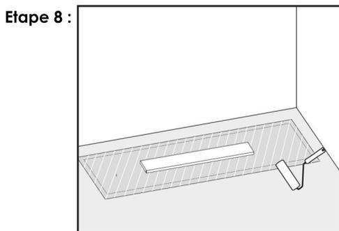
Appliquez à nouveau une couche de revêtement imperméable sur la membrane imperméable.
