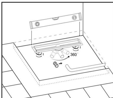
Placez le caniveau de douche là où il doit être installé, ajustez le niveau du caniveau de douche à l'aide de pieds de réglage (mesurer avec un niveau à bulle). Le connecteur à 360 degrés est capable de pivoter de manière flexible dans la position appropriée.
