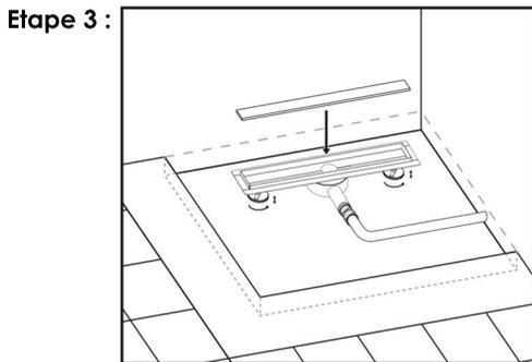
Avant l'installation du drain de douche, des matériaux de protection doivent être placés (comme une pièce en polystyrène, disponible dans l'emballage)
