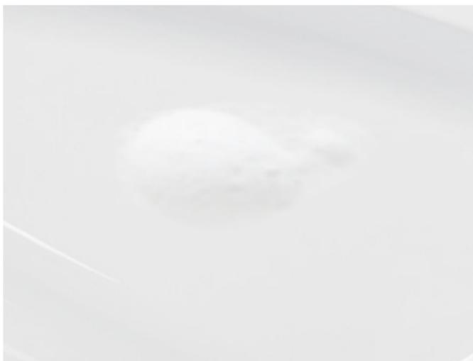
L'apparition de cloques (ou phénomène d'osmose) est le résultat d'une mauvaise application de la fibre sur la couche d'acrylique. L'humidité déjà présente au thermoformage ou à posteriori par infiltration, entraîne le décollement de la fibre.
