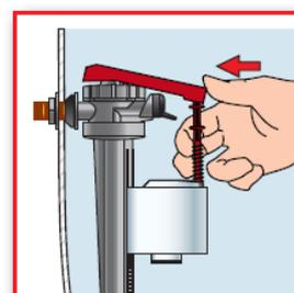
Dévisser l'écrou de la tête, sous le levier rouge et savonner le joint à l'intérieur de cette tête pour la rotation.
