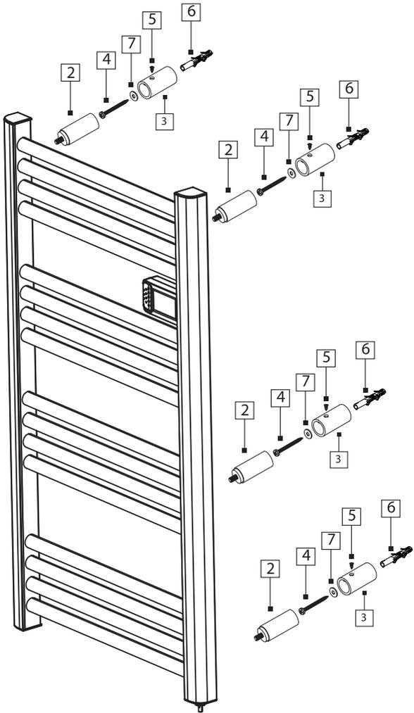
1. Placez les supports avec des vis dans les quatre trous de l'appareil. Veuillez noter que le curseur intégré vous permet de régler la hauteur des supports. La distance maximale entre les supports supérieur et inférieur est égale à la longueur totale de l'appareil. Assurez-vous que les supports horizontaux à droite et à gauche sont situés à la même hauteur.
