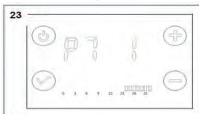
Appuyez sur [+] pour démarrer la détection de fenêtre ouverte (Fig. 26). Vous pouvez modifier l'heure de reprise du chauffage. Sélectionnez [0] [65] ou [90], qui est le nombre de minutes après lequel le fonctionnement de l'appareil reprendra. Après avoir entré le paramètre souhaité, appuyez brièvement sur l'icône [✓] pour entrer d'autres paramètres.
