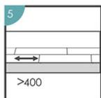
**5** La distance minimale entre les extrémités courtes des planches dans les rangées, ne doit pas être inférieure à la longueur donnée.
