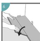
**6** Placez la planche inclinée contre la planche de la rangée précédent, appuyez vers l'avant et repliez en même temps. Laissez la planche en position légèrement inclinée vers le haut lorsque les planches commencent à se verrouiller. Pour ce faire, un coin avec l'angle approprié, peut être placé comme support sous la planche près du joint latéral court.
