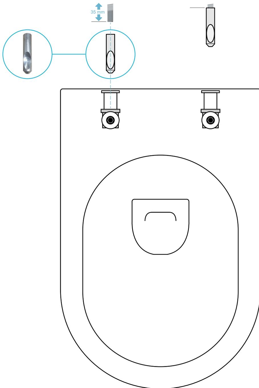
Enfiler la cuvette sur les tiges de fixation, jusqu'à la plaquer contre le coffrage du bâti-support.
