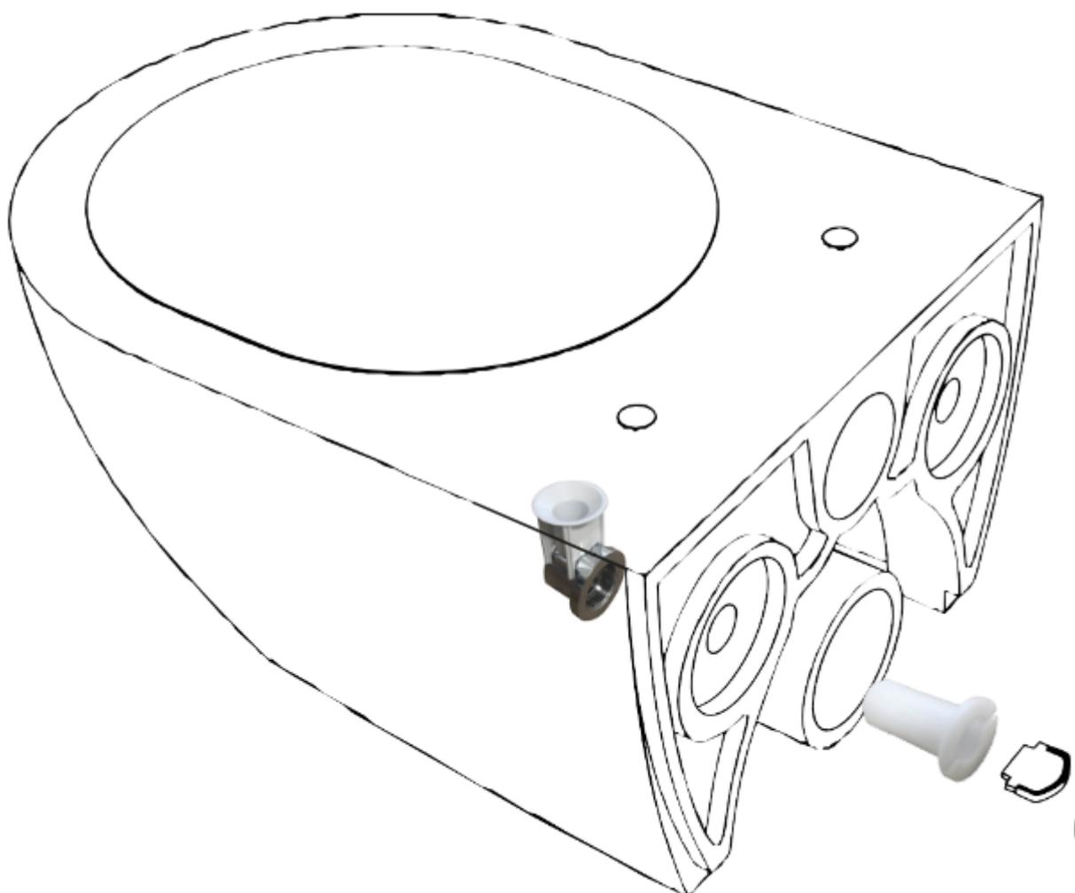
Une fois le coffrage du bâti-support fini, recouper si nécessaire les tiges filetées afin qu'elles dépassent de 35 mm. Puis visser les tiges de fixation, en laissant environ 10 mm de filetage apparent et en positionnant les méplats vers le haut.
