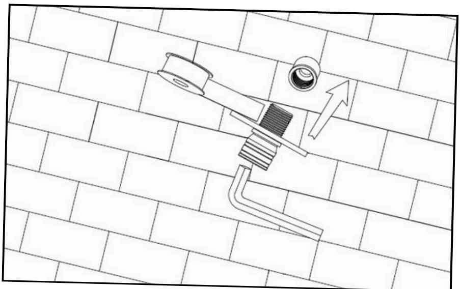
Desserrer la vis à six pans, mettre le joint d'entrée d'eau (Composant 2) sur le décontracté, enrouler le filetage extérieur avec du ruban adhésif pour métaux (téflon) et serrer la sortie d'eau (raccord) fixée sur le mur avec une clé à double hexagone. Retirer le connecteur d'entrée d'eau.
